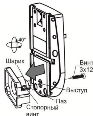
**12** Провести провода от источника питания и шлейфа сигнализации через отверстие для ввода проводов в основании извещателя
