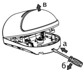
**2** Отогнуть зацеп на основании. Снять плату
