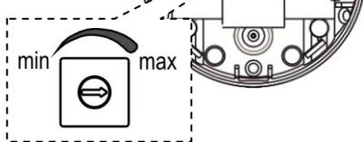
**24** Включить питание извещателя. В течение времени выхода извещателя в дежурный режим снять переключатель с вилки **Ind** (включается на 8 мин режим тестирования ИК-канала)
