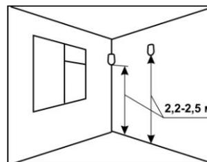
8.4.2 Извещатель следует крепить к несущим элементам конструкции, не подверженным вибрациям.
