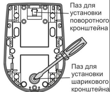
**10** Сделать разметку крепежных отверстий на выбранном месте по приложенному **кронштейну**. Закрепить кронштейн на стене
